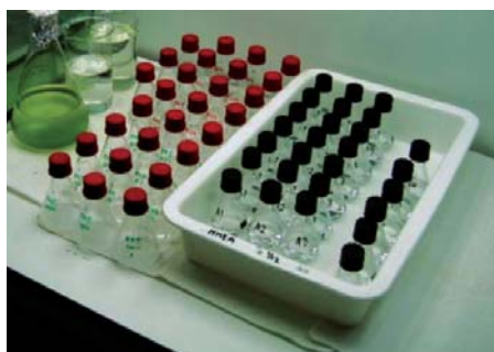
Hình 3. Hệ thống thử nghiệm độ độc trên Acaria tonsa
