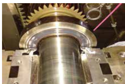
Đĩa chặn trên trục rotor bị bào mòn, quá nhiệt
