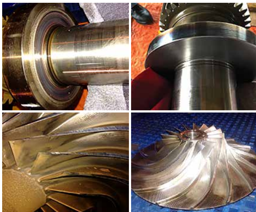
Hình 18. Rotor cấp 3 và 4 trước và sau khi phục hồi
