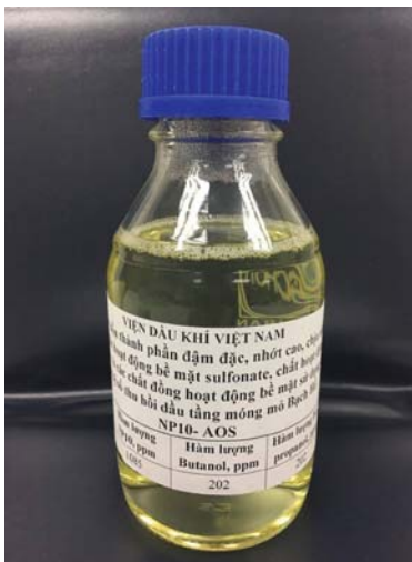
Hình 1. Hệ hóa phẩm 4 thành phần áp dụng cho bơm ép tăng cường thu hồi dầu
