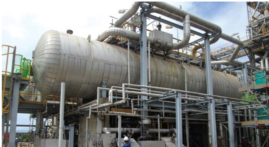
Hệ thống thiết bị tách muối trong dầu thô tại Phân xưởng CDU
